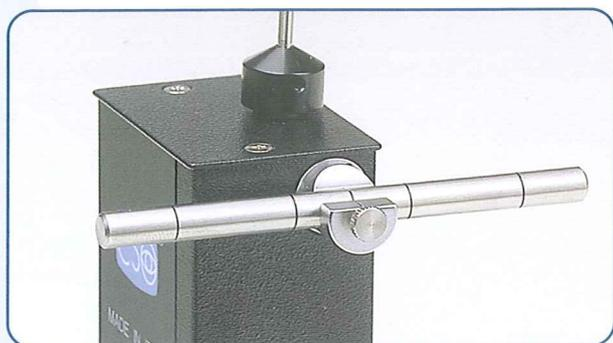
Il tonometro ad applanazione funziona secondo il metodo "Goldmann": misura, cioè la pressione necessaria per mantenere un'applanazione uniforme della superficie della cornea. La misurazione esatta della piccola superficie di applanazione è effettuata con una lampada a fessura con un ingrandimento 10x.
